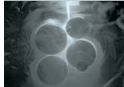
Gestein wird geschmolzen und zerfasert; unter Zugabe von Bindemittel wird ein Faserteppich produziert und kommt in den Härteofen
